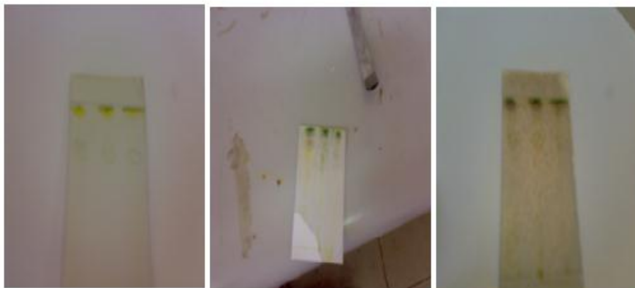
Figura 3- Cromatogramas de extracto de acetato de etilo. Fase móvel : n -hexano, Clorofórmio e etanol (1,0:1,5:1,0 v/v). Aplicação de extractos da esquerda para direita: B. discolor , T. sericea , S. kraussii
