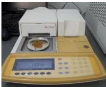
Figura 6. Analisador de humidade.
