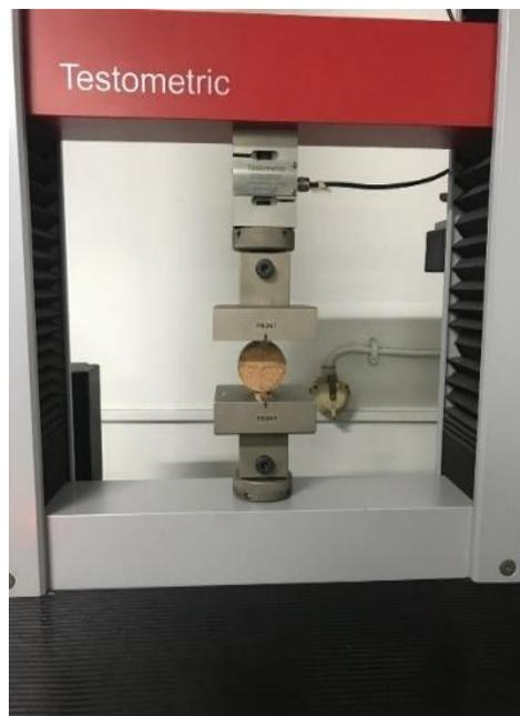
Figura 8. Ensaio de resistência por compressão diametral dos briquetes.
