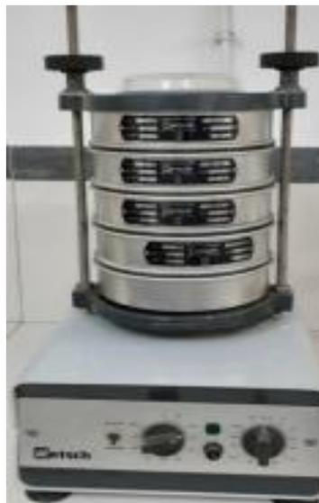
Figura 5. Peneiradora vibratória.
