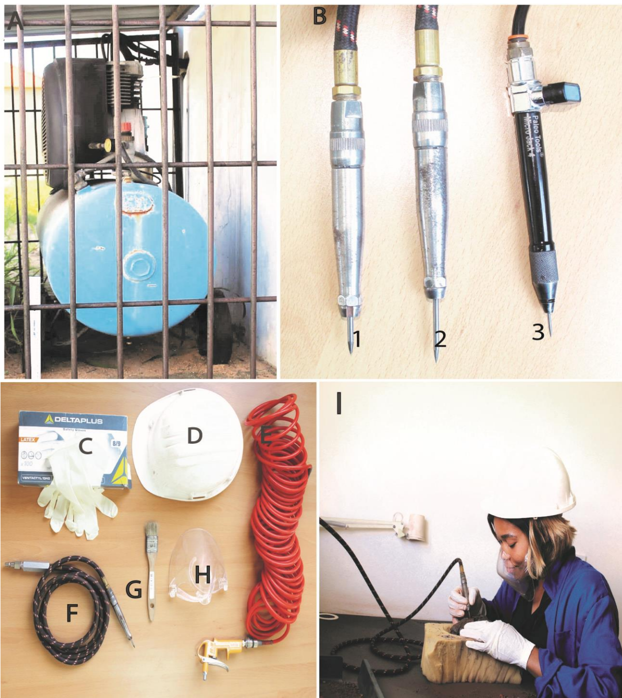
Figura 5. A-Ilustra o compressor de ar que permite o funcionamento dos micromartelos, B- Chicago Pneumatics ME9100 1, 2 e o PaleoTools MicroJack-5 3. C-luvas, D-capacete, E-pistola de ar, F-paleoaro, G-pincel, H-mascara, I-ilustra o processo de preparação mecânica.
