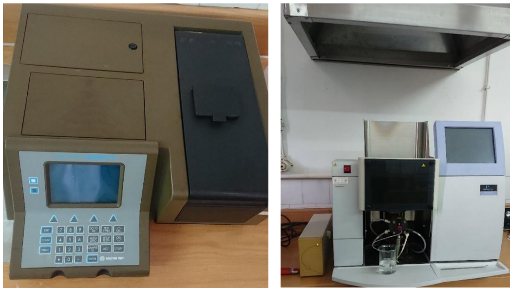
Figura A 3. Espectrofotómetro de Absorção Molecular à esquerda; Espectrofotómetro de Absorção Atómica à direita
