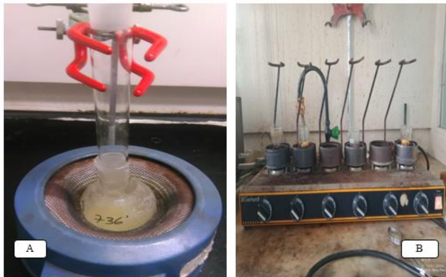
Figura 12: (A) Processo de fervura da amostra juntamente com a solução de Bellucei; (B) Processo de carbonização do resíduo resultante da filtração.
