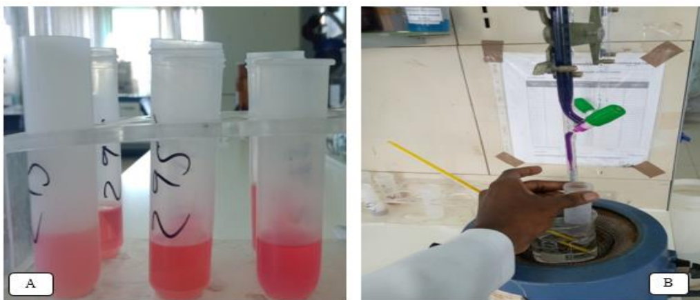
Figura 18: (A) Amostra em repouso para precipitação do cálcio; (B) Titulação das amostras após adição de ácido sulfúrico.
