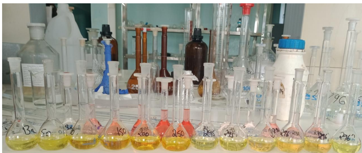
Figura 16: Soluções padrões, amostra e branco de fósforo em repouso à temperatura ambiente.
