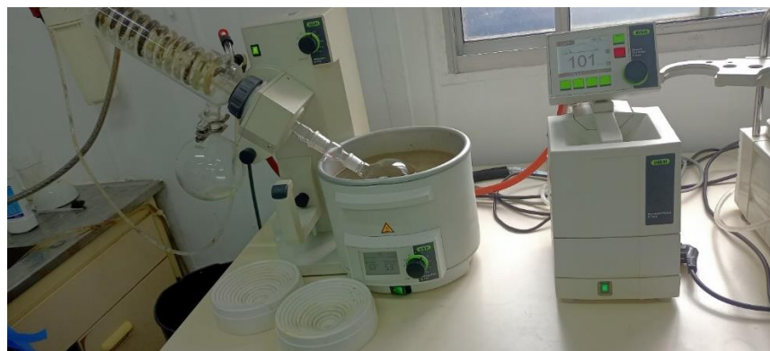
Figura 10: Imagem ilustrativa do processo de evaporação do solvente de extracção
