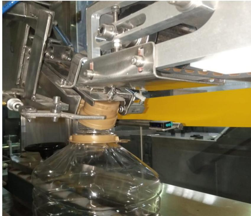
Figura 5: Processo de enchimento de óleo alimentar. Fonte (Adaptado Pelo Autor, 2023).
