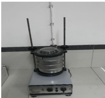
Figura 17. Mesa vibratória acoplada a peneiras utilizada para a classificação granulométrica dos finos de carvão vegetal
