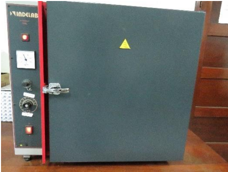
Figura 14. Estufa de circulação forçada de ar utilizada para a secagem das amostras
