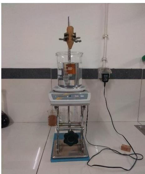
*Figura 13. Ilustração da determinação da densidade da madeira estudada*
