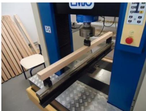
*Figure 2. Teste de resistência a flexão estática na madeira.*
