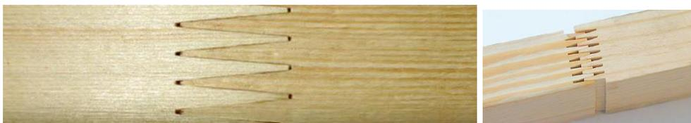
Figure 6. *Ligação colada. finger-joint.*
