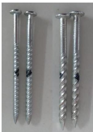
*Figure 14. Pregos usados nos testes de resistência ao arrancamento. Pregos de 3,6mm à esquerda e prego de 4,7mm à direita.*
