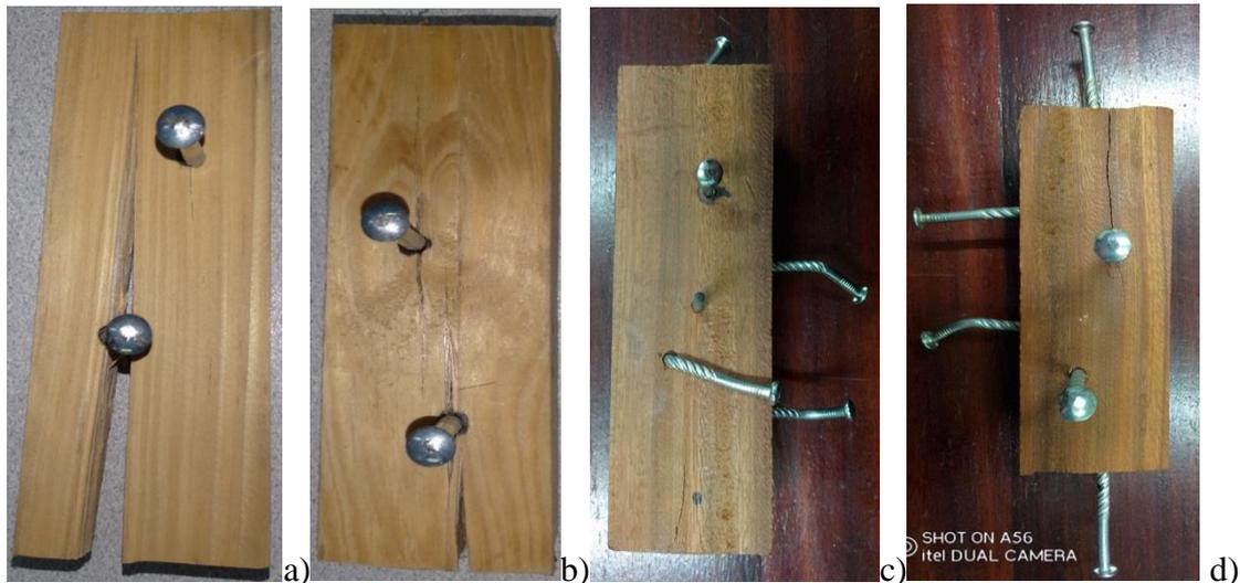
Figure 16. Rachadura no plano radial e tangencial (a e b), causada pelo prego durante a sua inserção e pregos dobrados na madeira de messassa encarnada (c e d).
