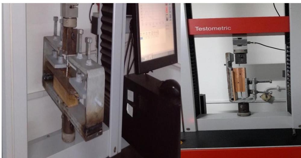
Figura 15. Ilustração da fixação da amostra de madeira na máquina de ensaios para retirada do prego nos planos radial ou tangencial (A) e transversal (B).
