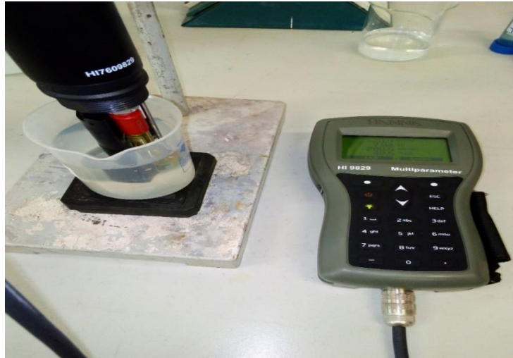
Figura 9. Medidor multiparamétrico com eléctrodo de ião selectivo
