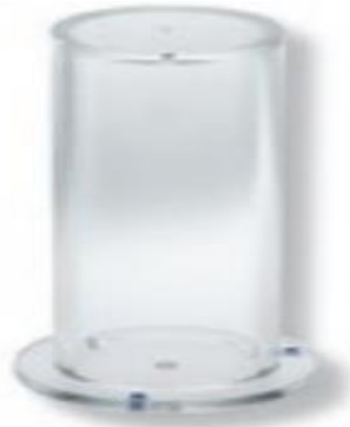
Figura 3.5: Cilindro de teste de alinhamento central do feixe de raios-X (Iba D. , 2007)
