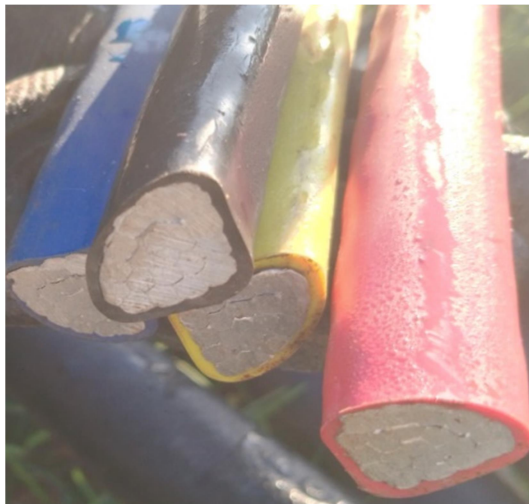
Figura 5: Cabo LVAV (Fonte: Autor, 2024)
