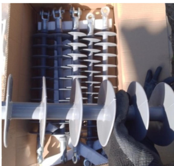
Figura 2: Cadeia de Isoladores (Fonte: Autor)
