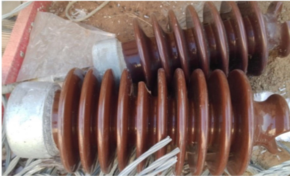
Figura 3: Isolador de porcelana (Fonte: Autor 2024)
