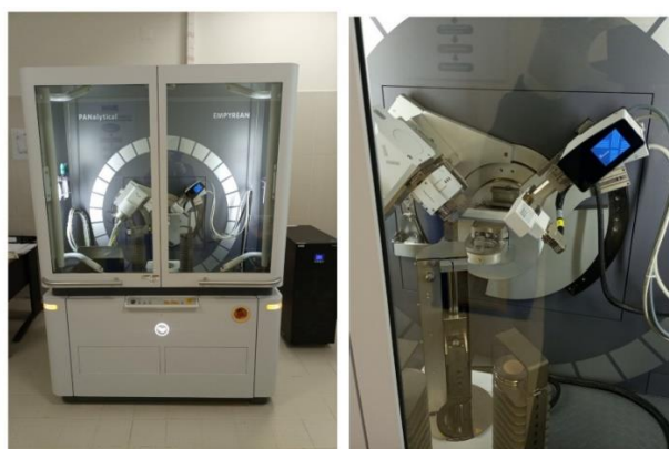
Figura 24: Aparelho usado para a análise por DRX.
