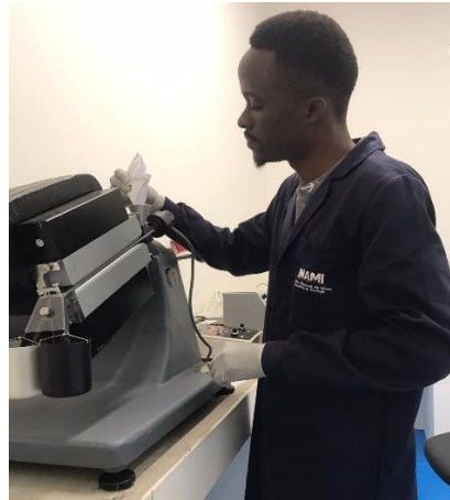
Figura 20: Operação no separador Isodimâmico Frantz.
