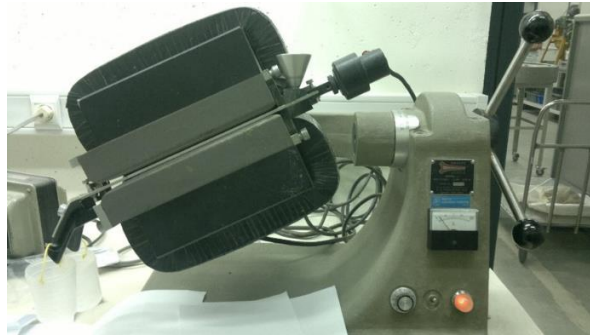
Figura 12: Separador magnético isodinâmico de Frantz.
