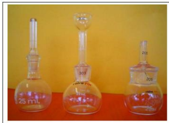
Figura 8: Picnômetros utilizados para determinação de densidade de sólidos.
