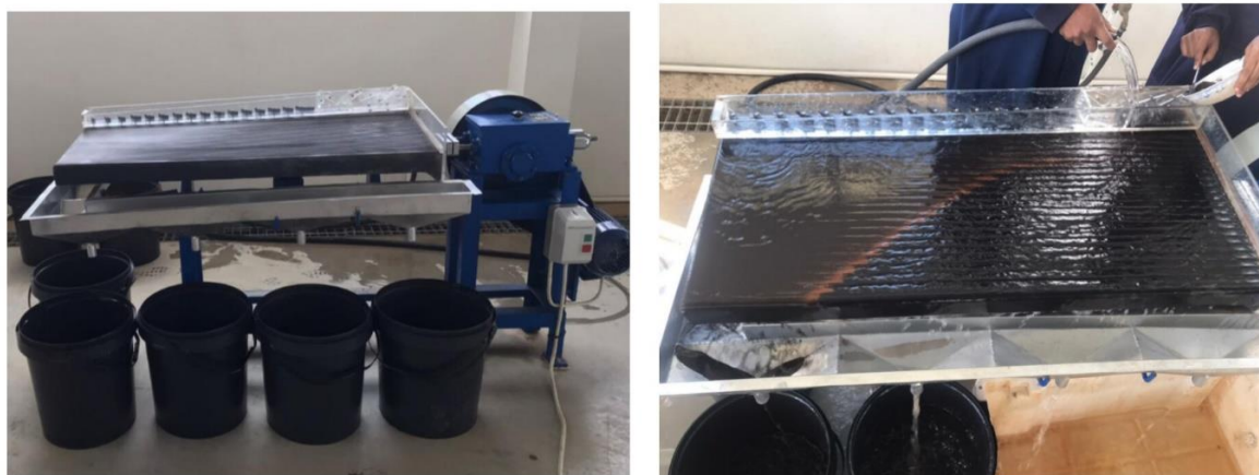
Figura 19: Organização da mesa (à esquerda) e separação gravítica da amostra (à direita).
