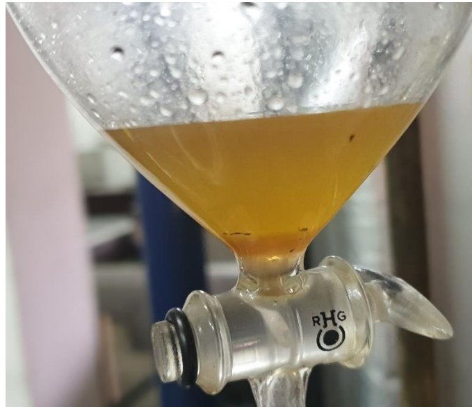
Figura A3-2: Separação da glicerina do biodiesel.
