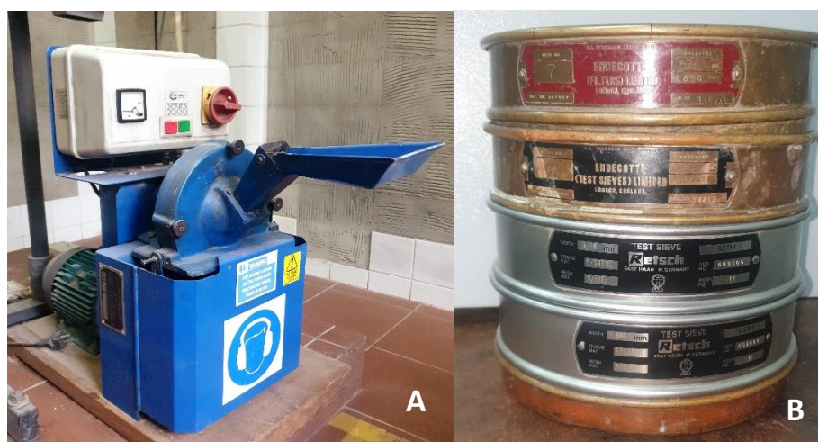
Figura 20: Equipamentos utilizados: Moinho de martelos (A) e crivos (B)
