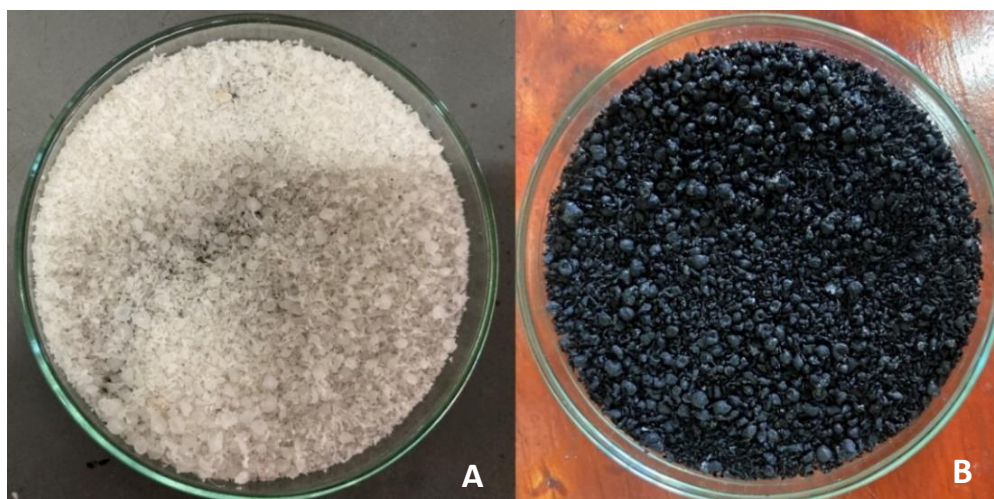
Figura 27: Polipropileno (A) e polipropileno sulfonado (B).
