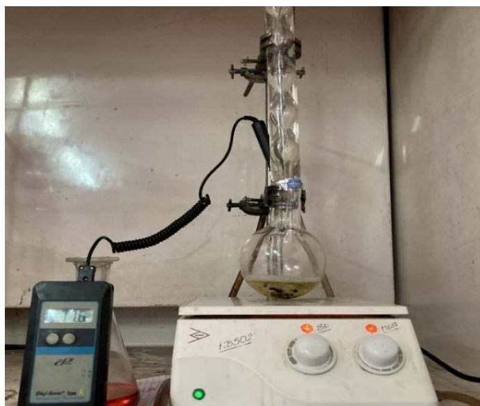
Figura 24: Sistema montado para síntese do biodiesel.
