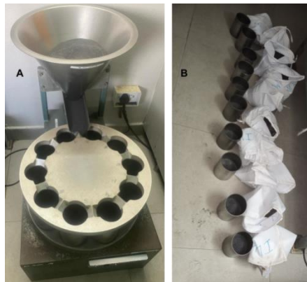
Figura 15: A - Homogeneização e quarteamento da amostra no divisor rotativo, B - Distribuição da amostra representativa em sacos de amostragem.
