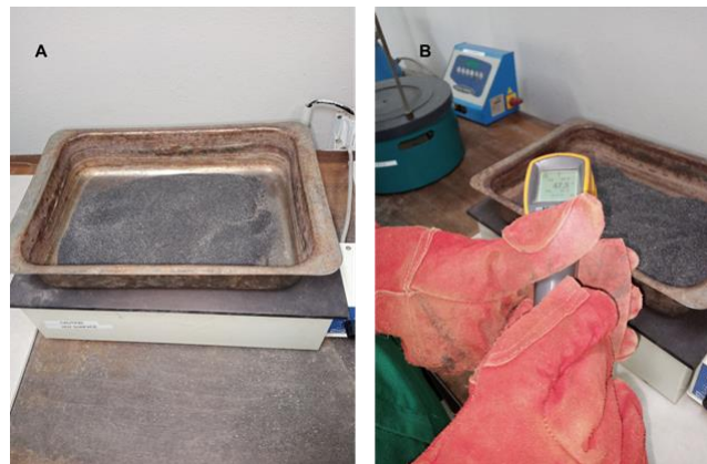
Figura 18: A- Aquecimento da amostra na chapa quente, B-Medição da Temperatura da amostra usando um termopar do tipo pistola.
