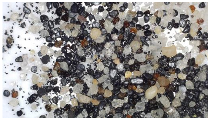
Figura F4.2- Fração correspondente aos tamanhos de 500, 710 e 1000 \mu\text{m} .
