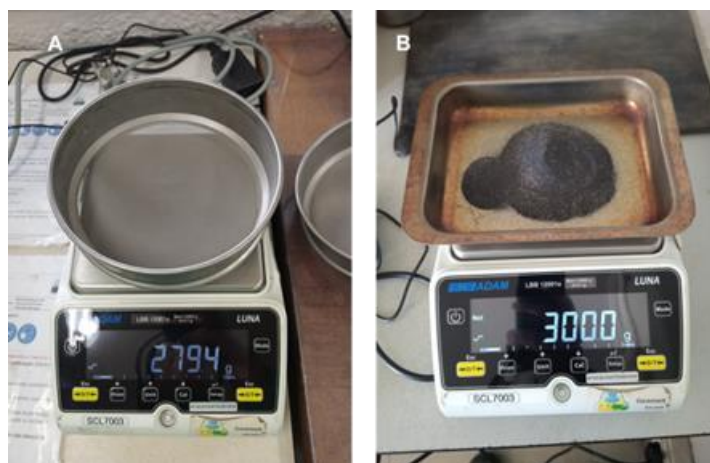
Figura 16: A- Pesagem da massa dos peneiros e B- pesagem da massa que alimenta os peneiros na crivagem.
