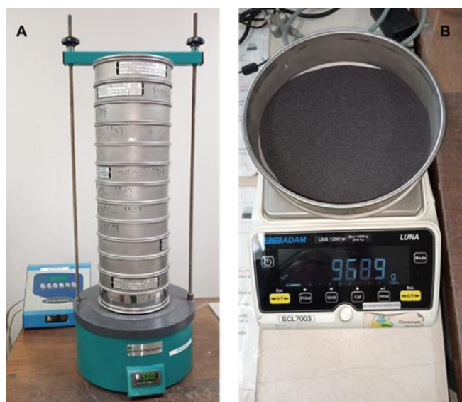
Figura 17: A-Procedimento para análise granulométrica por peneiramento, B-pesagem da fracção retida no peneiro.
