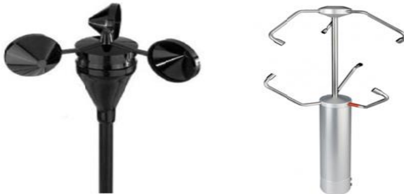
Figura 15: Anemómetro de copo e Anemómetro sónico, Respectivamente.
