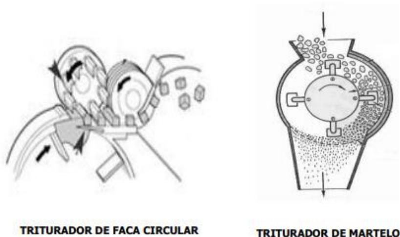
Figura 2.3.: Operação de redução de tamanho para alimentos sólido[30].
