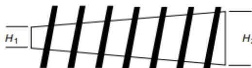
Figura 2.13: Parafuso com aumento do diâmetro. fonte [31]
