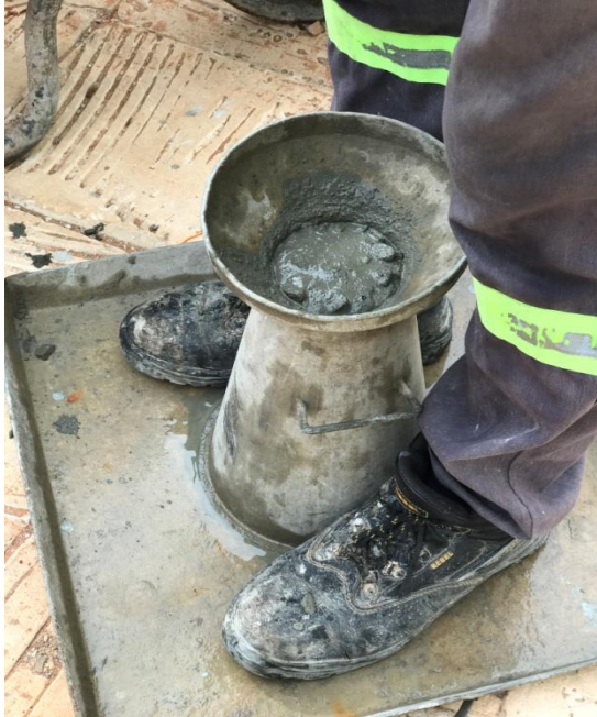
Figura 38 – Preenchimento do cone de Abrams com betão ( Fonte: Própria)
