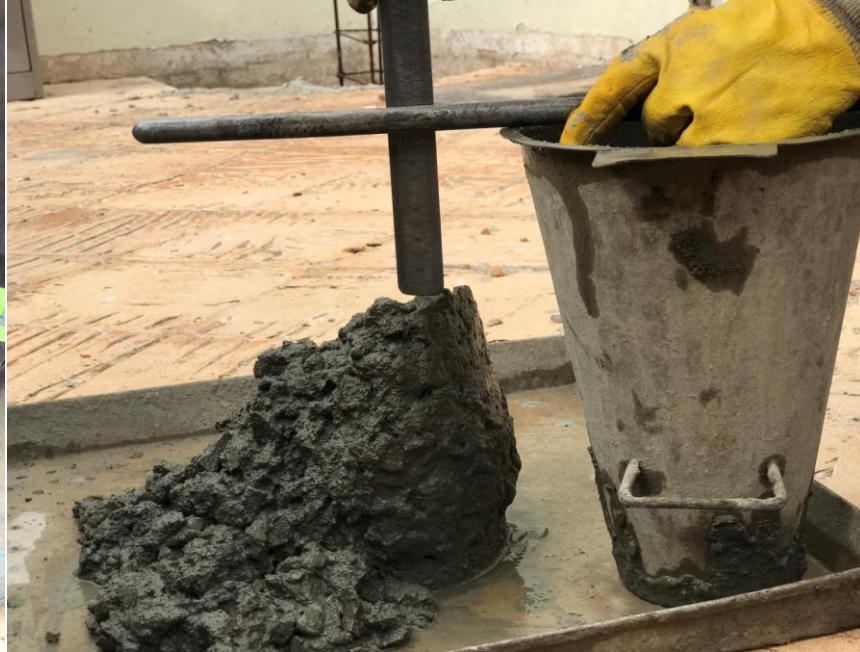
Figura 39 – Leitura do ensaio do cone de Abrams ( Fonte: Própria)
