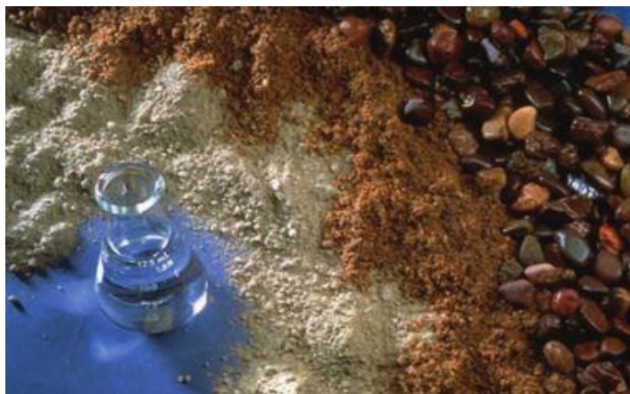
Figura 2 – Componentes do betão: água, cimento, areia e agregados (Fonte: De Sousa Coutinho, 2006 )
