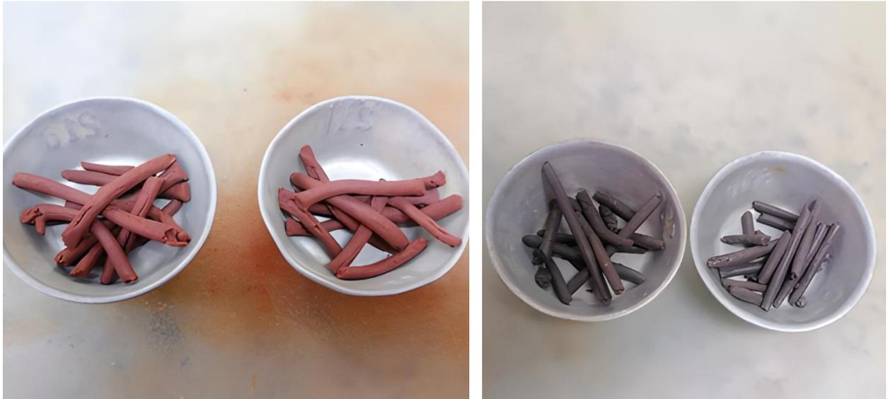
**Figura 3. 4** – Rolos de 3,2 mm de diâmetro para determinação do limite de plasticidade das escolas ICM e ESEFJN, respectivamente
