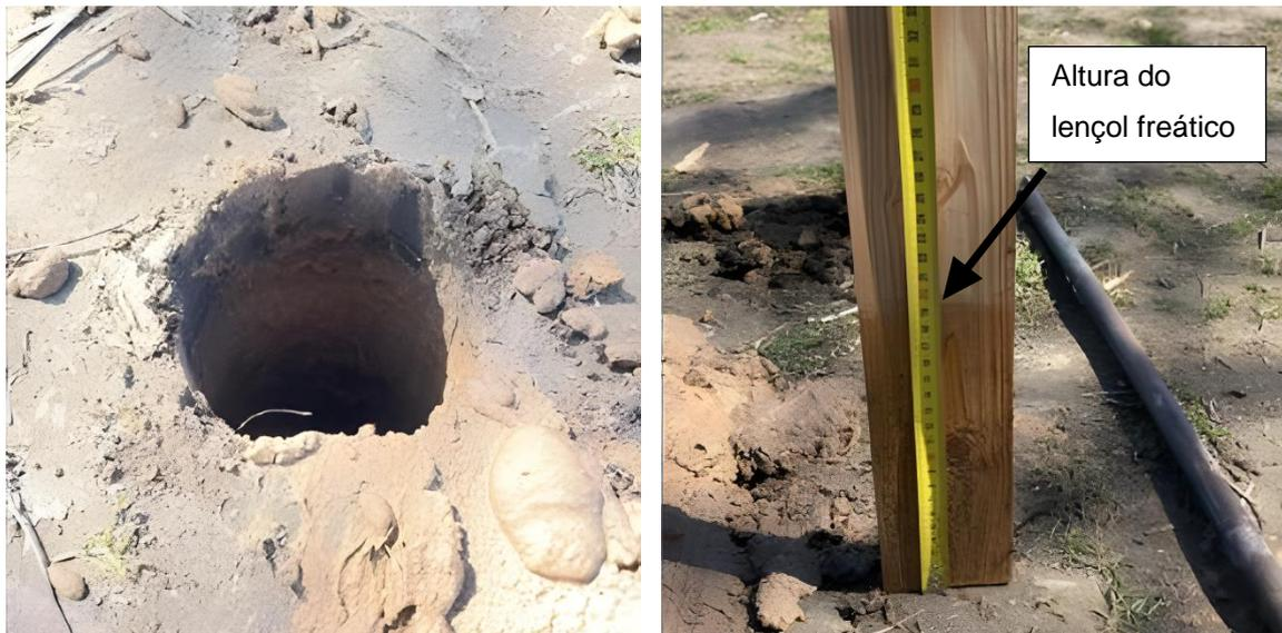
**Figura 4. 9** – Registo fotográfico do segundo furo de Sondagem e de uma das alturas do nível freático, ESL
