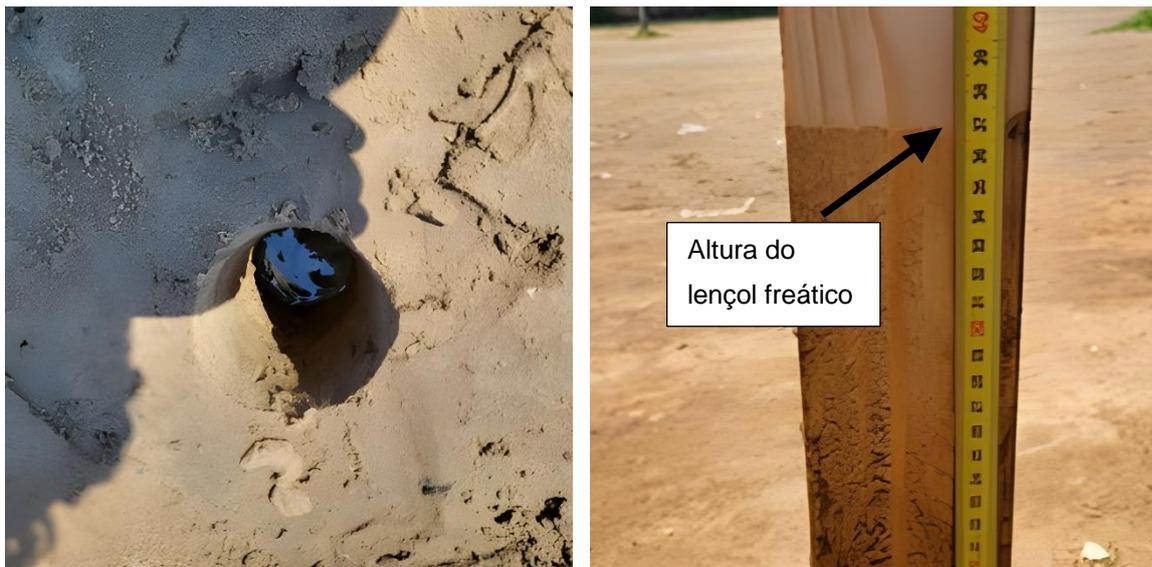
Figura 4. 21 – Registo fotográfico do furo perfurado e de uma das alturas do lençol freático no terceiro furo de Sondagem, ESN2
