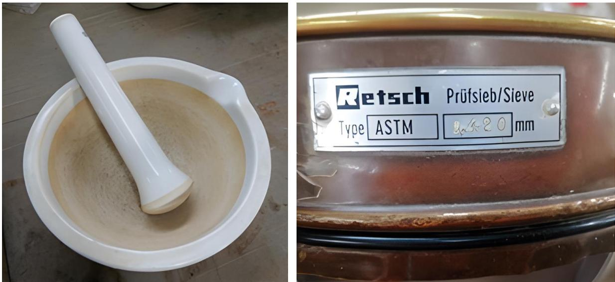
Figura 3. 2 – Equipamentos para determinação dos limites de Atterberg
