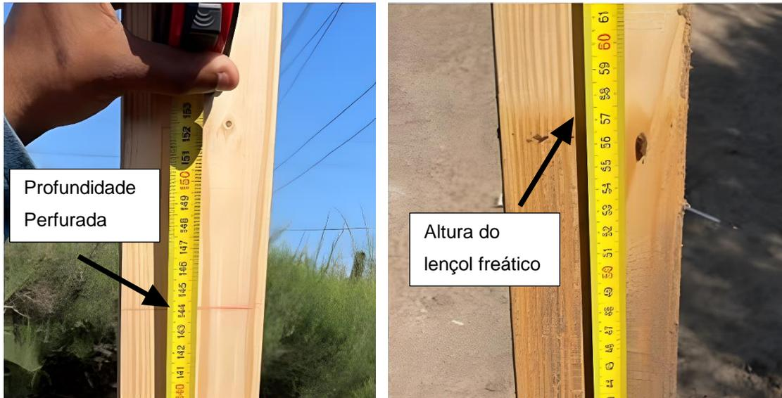
**Figura 4. 10** – Um dos registos da profundidade perfurada e da altura do lençol freático no terceiro furo de Sondagem, ESL
