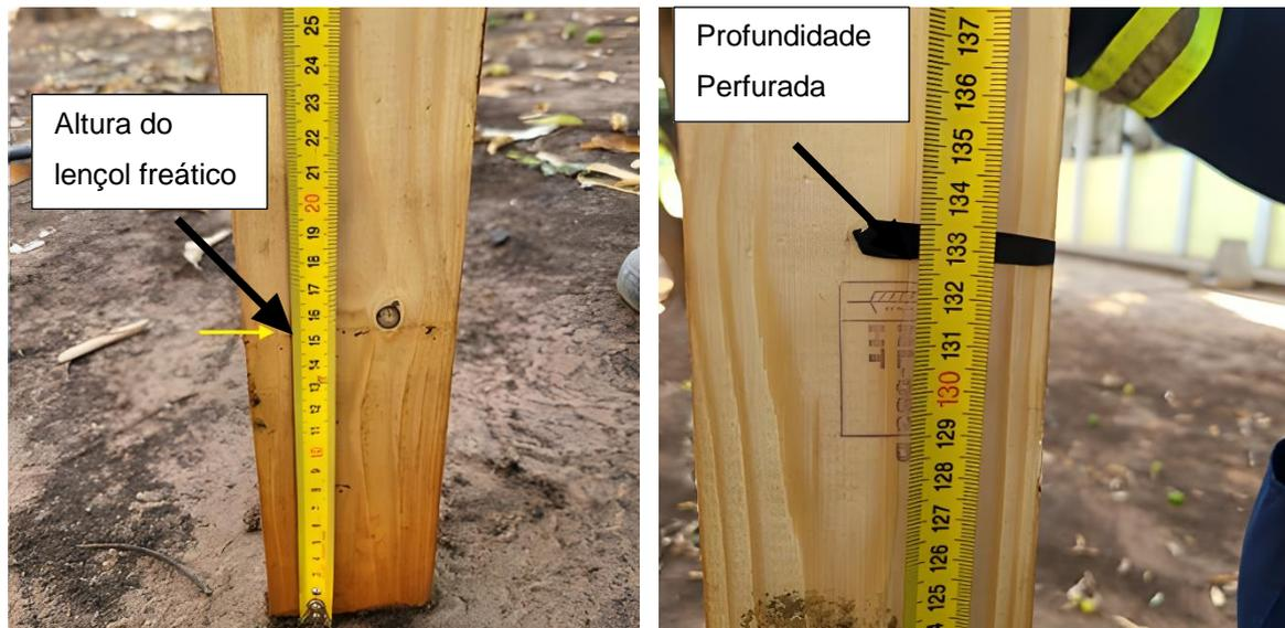
**Figura 4. 15** – Um dos registos da profundidade perfurada e da altura do lençol freático no segundo furo de Sondagem, IICM
