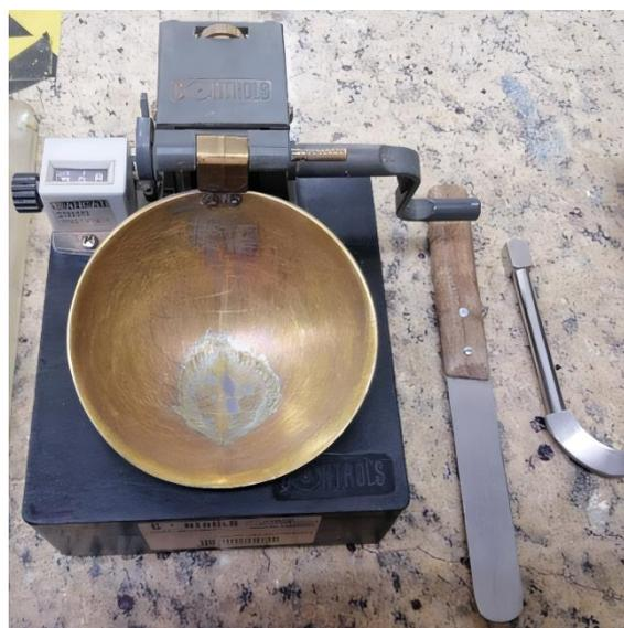
**Figura 3. 5** – Concha de Casagrande para determinação do Limite de Liquidez
