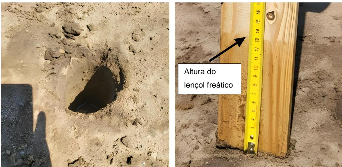
**Figura 4. 19** – Registo fotográfico do furo perfurado e de uma das alturas do lençol freático no primeiro furo de Sondagem, ESN2
