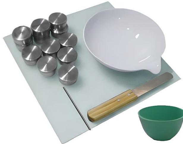
**Figura 3. 3** – Material para determinação do Limite de Plasticidade
