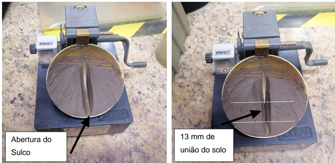
**Figura 3. 6** – Amostra do solo, da escola secundária de Chinonanquila, com o sulco aberto e com a união de uma distância de 13 mm do comprimento do sulco
