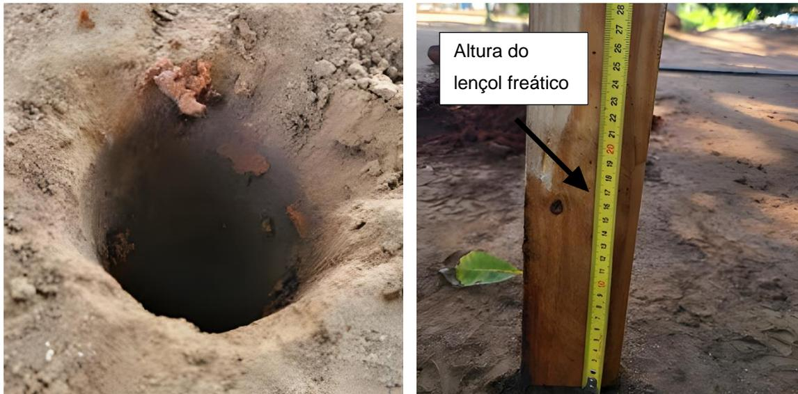
Figura 4. 14 – Registo fotográfico do furo perfurado e de uma das alturas do lençol freático no primeiro furo de Sondagem, IICM
