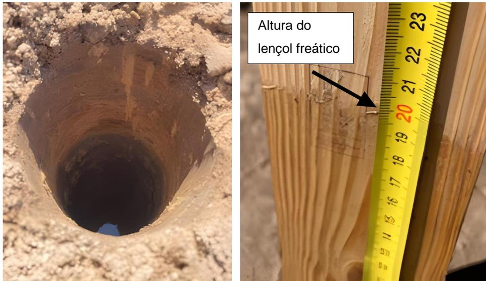
**Figura 4. 8** – Um dos registos fotográficos da altura do lençol freático no primeiro furo de Sondagem, ESL
