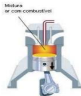
Figura 17: Deslocamento do pistão pela força de expansão dos gases, transformando a energia térmica em mecânica.
