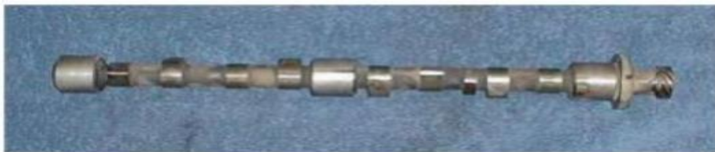
Figura 8: Partes de um motor a diesel, comando de válvula.
