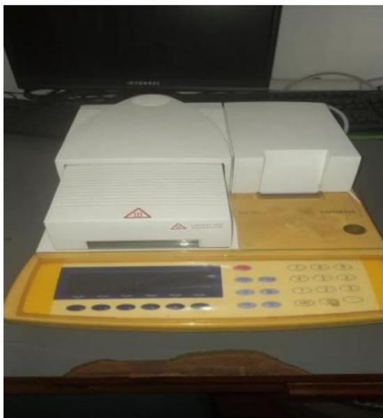
Figura 6. Analisador de humidade. Fonte: Autora (2024).
