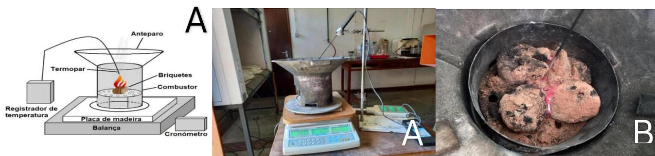
Figura 10. A: Sistema montado para realização do teste índice de combustão. B: briquetes durante a queima. Fonte: Autora (2024).
