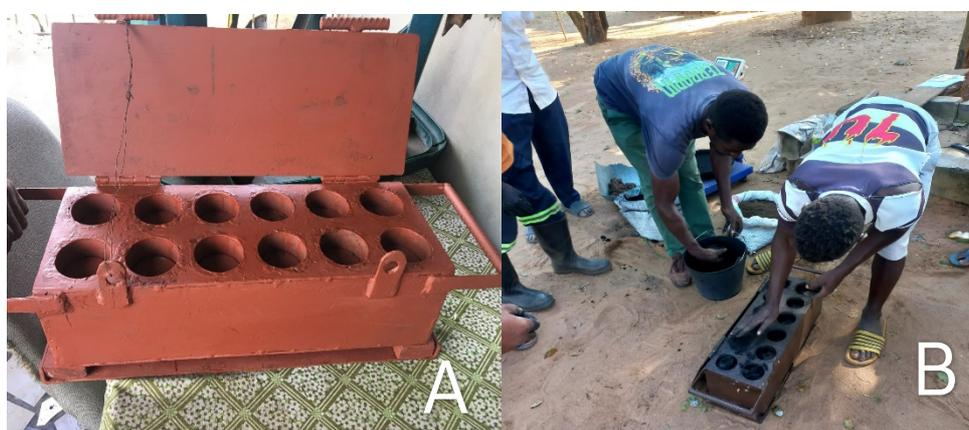
Figura 2. A: Briquetadeira usada para moldar os briquetes; B: Processo de enchimento da briquetadeira.
