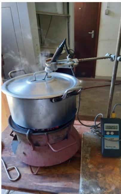
Figura 9. Fase de alta potência do teste de fervura de água. Fonte: Autora (2024)
