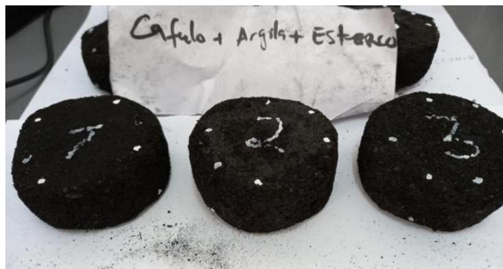
Figura 3. Pontos de medição de alturas e diâmetros. Fonte: Autora (2024).
