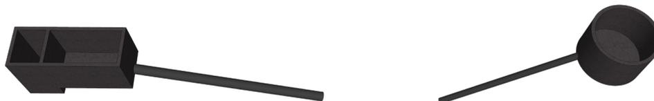
A caixa de saída, ao contrário da de entrada, é cavada e deve ficar abaixo do nível do terreno. Para que a descarga aconteça corretamente, o seu nível deve estar abaixo do nível da carga. A caixa de saída tem 2 níveis de profundidade. Ela deve ficar semi-enterrada em uma trincheira com pouco mais de 1,60 m de comprimento para todo o reservatório.
