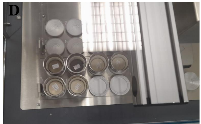
Figure 14: Preparação das amostras de bentonite para a análise de FRX; A: Após a preparação de 1g de amostra e 10g de fundente, as amostras foram introduzidas em frascos; B: As amostras foram prensadas em um equipamento adequado para a introdução das mesmas no equipamento; C: Amostras prontas para serem analisadas; D: Amostras introduzidas ao equipamento; Fonte: Autora, 2024.
