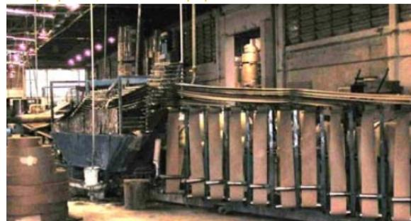
**Fig.10:** Faixas de papel kraft dispostas na máquina de produção de tubos de papelão. Fonte: SALADO, G. (2006)
