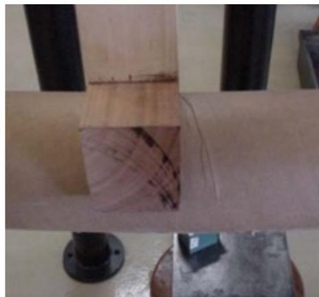
**Fig.36:** Corpo-de-prova recebendo carga superior ao seu limite de resistência. Fonte: Foto feita por Gerusa Salado.
