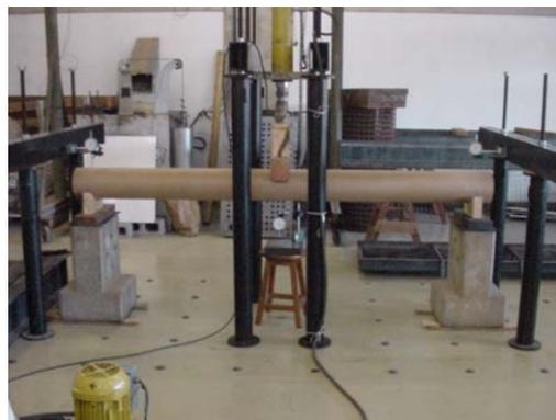
**Fig.31:** Corpo-de-prova preparado para o ensaio de resistência à flexão. Foto feita por Gerusa Salado.
