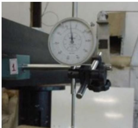
**Fig.35:** Perda de contato entre o corpo-de-prova e o seu deflectômetro. Fonte: Foto feita por Gerusa Salado.
