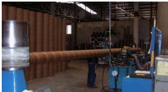
**Fig.12:** Faixas de papel kraft a ser enroladas no cilindro metálico. Fonte: SALADO, G. (2006)
