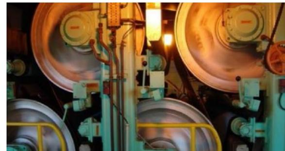
**Fig.08:** Cilindros de secagem. Fonte: Souza, C. (2014)
