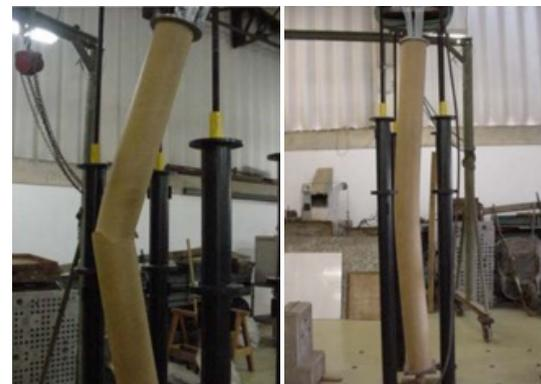
**Fig.23:** Tubo totalmente flambado e sem estabilidade e tubo rompendo com o acréscimo de carga. Fonte: Fotos feitas por Gerusa Salado.
