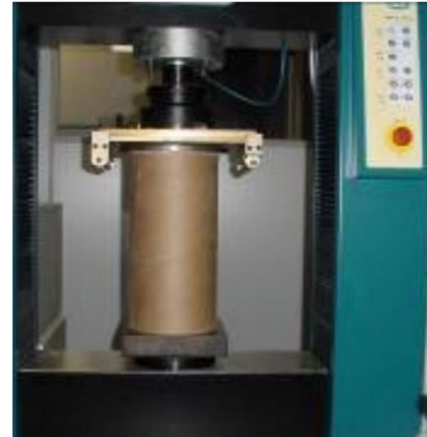
**Fig.17:** Corpo-de-prova durante o ensaio de resistência à compressão. Fonte: Foto feita por Gerusa Salado
