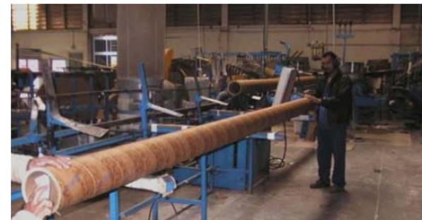
**Fig.13:** Corte do tubo de papelão. Fonte: SALADO, G. (2006)
