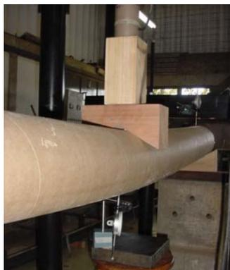
**Fig.32:** Corpo-de-prova durante o ensaio de resistência à flexão. Fonte: Foto feita por Gerusa Salado.
