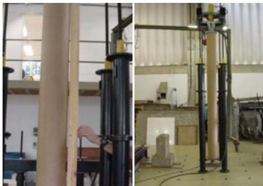
**Fig.21:** Corpo-de-prova antes da aplicação de carga e após o início da flecha. Fonte: Fotos feitas por Gerusa Salado.
