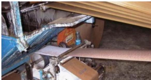
**Fig.11:** Passagem das faixas de papel kraft pelos tanques de cola. Fonte: SALADO, G. (2006)
