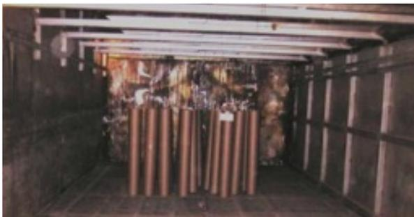
**Fig.14:** Tubos de papelão na estufa de secagem. Fonte: SALADO, G. (2006)
