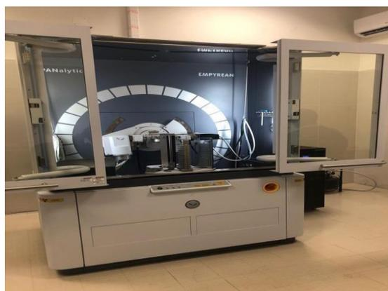
Figura 10: Difractômetro de Raios -X usado.
