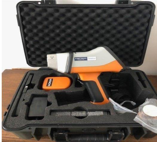
Figura 9: Espectrômetro de Fluorescência de Raios-X Portátil. Fonte: Geo smart center (2024)
