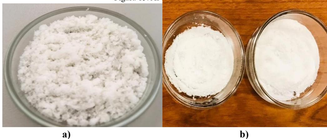
Figura 16 a) Cristais amorfos antes da calcinação. b) Amostra calcinada e pronta para análises.
