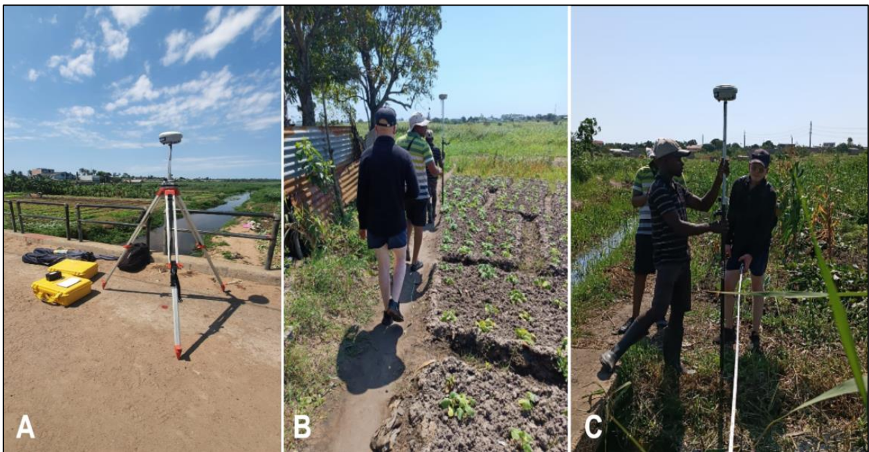
Figura A11.2: (A) Base do DGPS instalada na ponte da Zona verde; (B) Percorrendo o terreno com o “ Rover ” (antena) do DGPS ; (C) Leitura das altitudes de uma das secções transversais do rio, com o DGPS .
