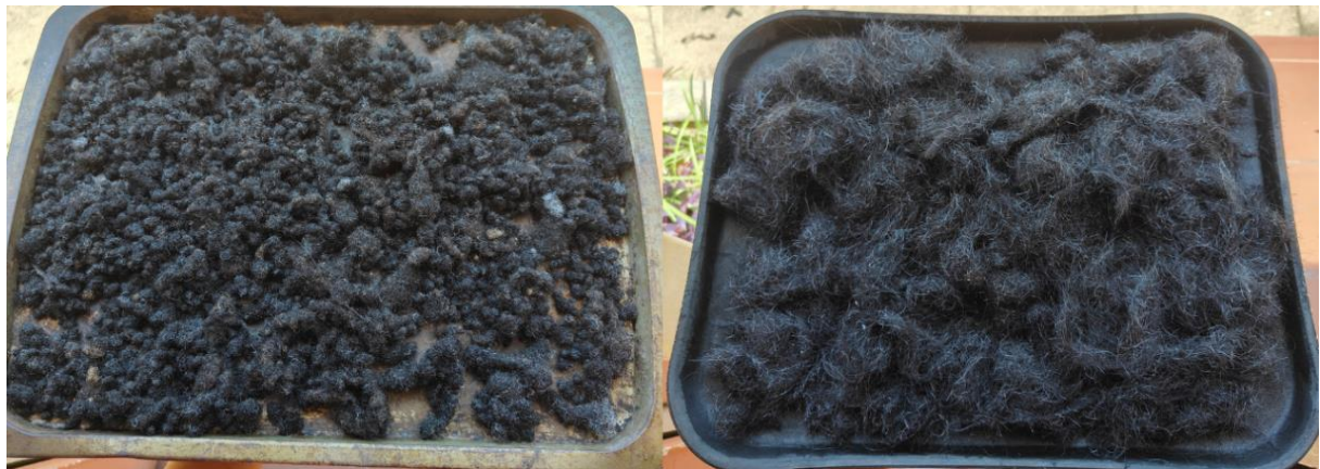
Figura 12: Amostras de cabelo usadas na experiência de adsorção (Crespo - esquerda e Liso - direita).
