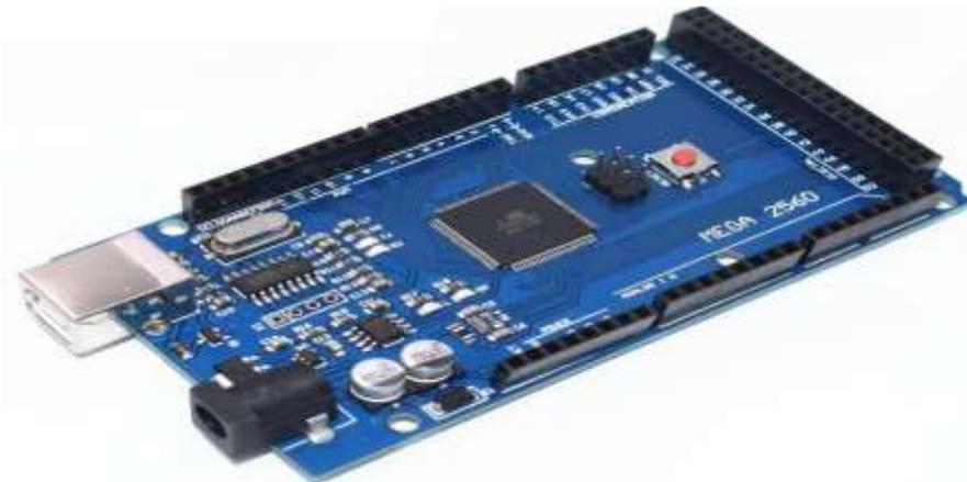
Figura 13: Arduíno Mega 2560 (Fonte: Arduino 2019)
