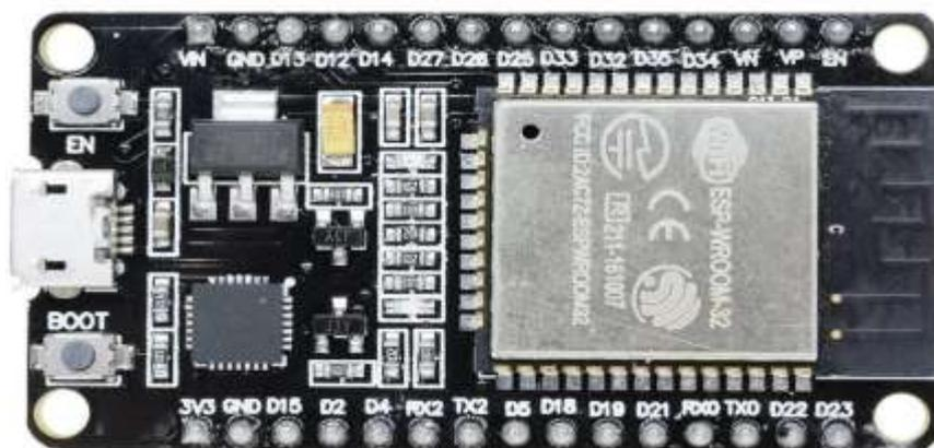
Figura 14: Microcontrolador ESP32 (Fonte: Koban (2018))
