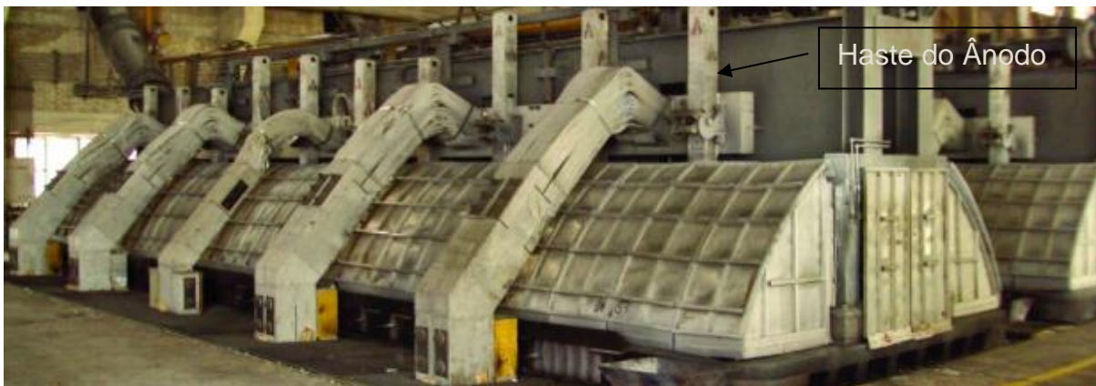
Figura 4: Representação de uma célula electrolítica moderna
