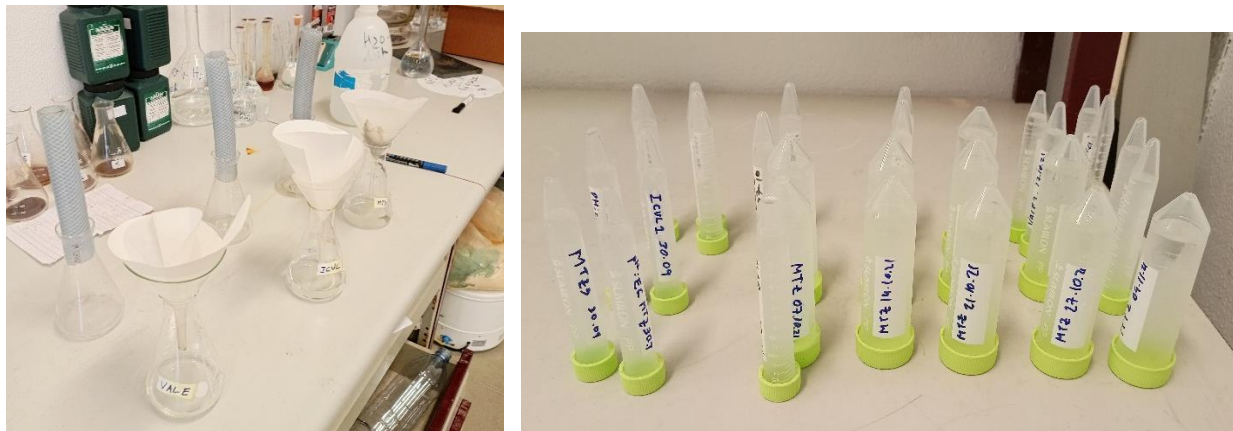
Figura 4. Filtração e armazenamento dos lixiviados.
