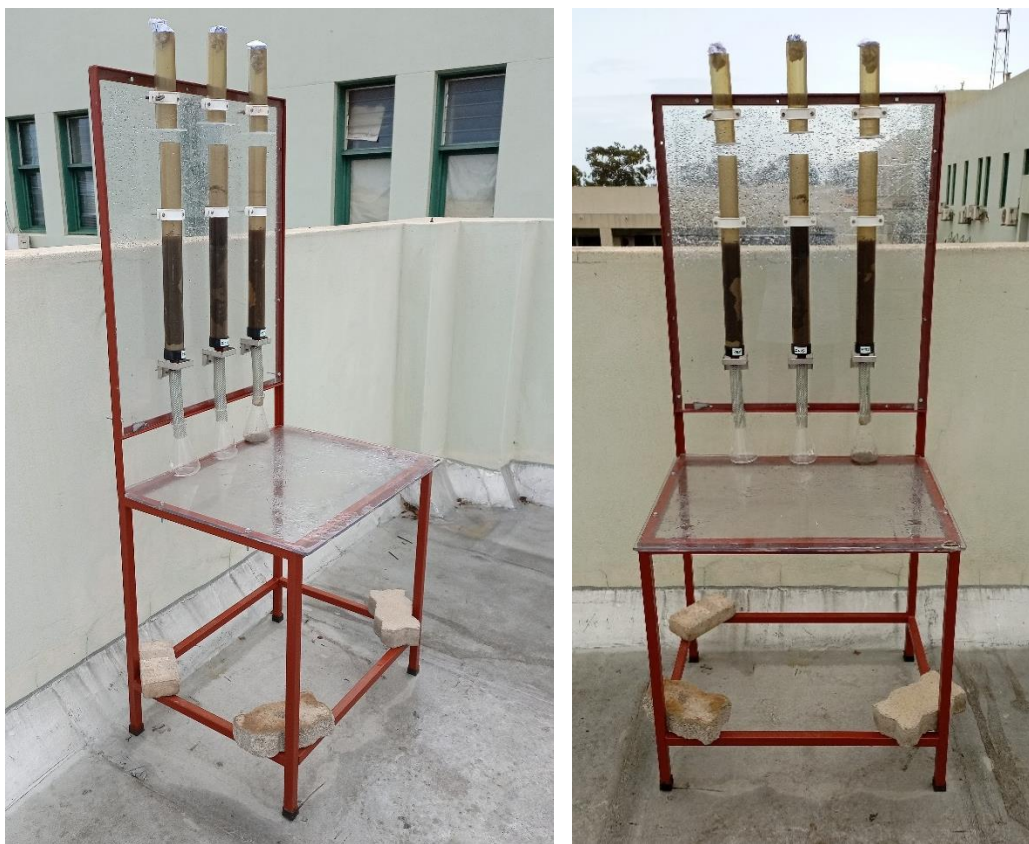
Figura 3. Bancada de Lixiviação usada para os ensaios.
