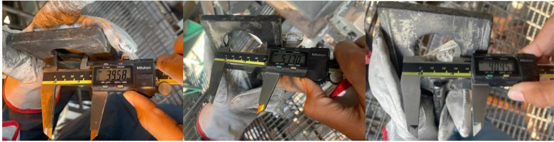
Figura A7-5: Orifícios da linha de circulação dos filtros 1, 2 e 3 respectivamente de diâmetros 39.58mm, 51.70mm e 40.45mm.
