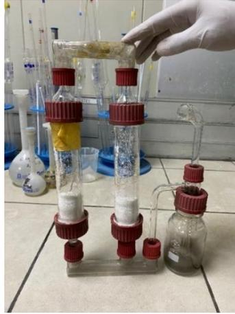
Figura 19: Aparato de vidro para suporte da resina e circulação do gás.
