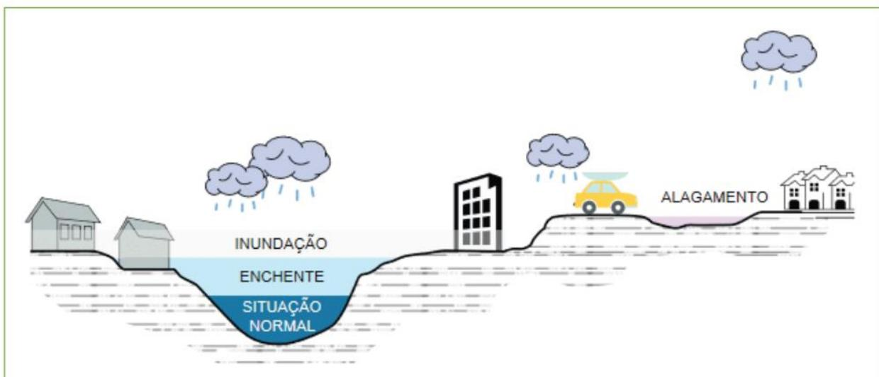
**Figura 7.** Ilustração dos conceitos de Enchente ou Cheia, Inundação e Alagamento. (Fonte: MOPHRH, 2020)
