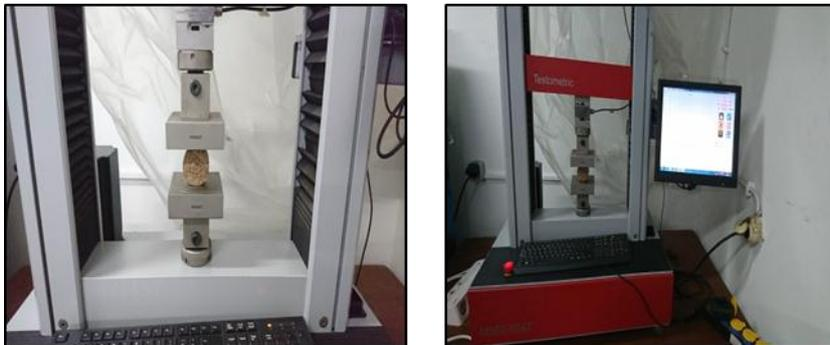
Figura 3.11: Equipamento utilizado para o ensaio de resistência à compressão.
