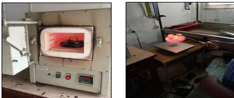
Figura 3.7: Mufla e os cadinhos utilizados na determinação do teor de voláteis
