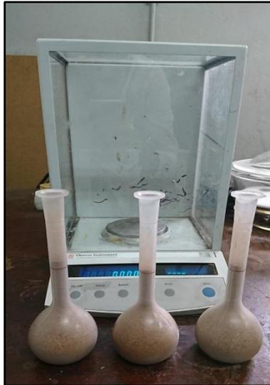
Figura 3.5: Balões volumétricos contendo biomassa para determinação de densidade a granel
