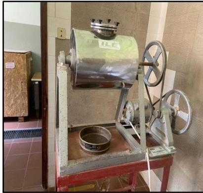
Figura 3.10: Moinho utilizado para executar o teste de friabilidade
