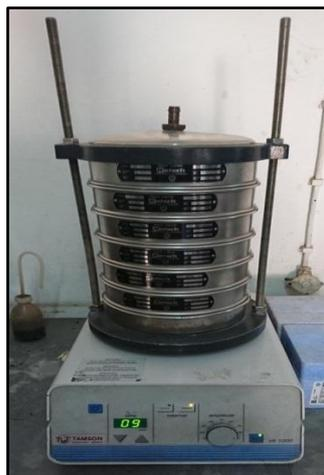
Figura 3.4: Conjunto de peneiros e agitador orbital
