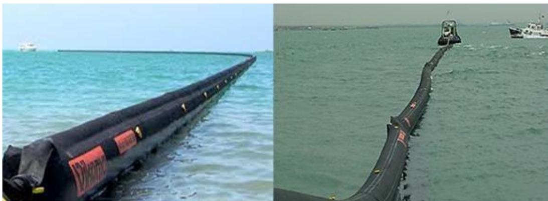
**Figura 6:** Barreira de contenção *Weir Boom*
