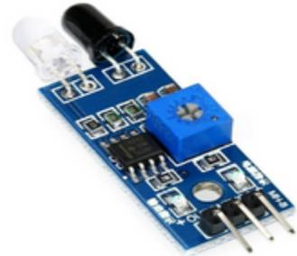
Figura 11: Sensores de Infravermelho (IR)
