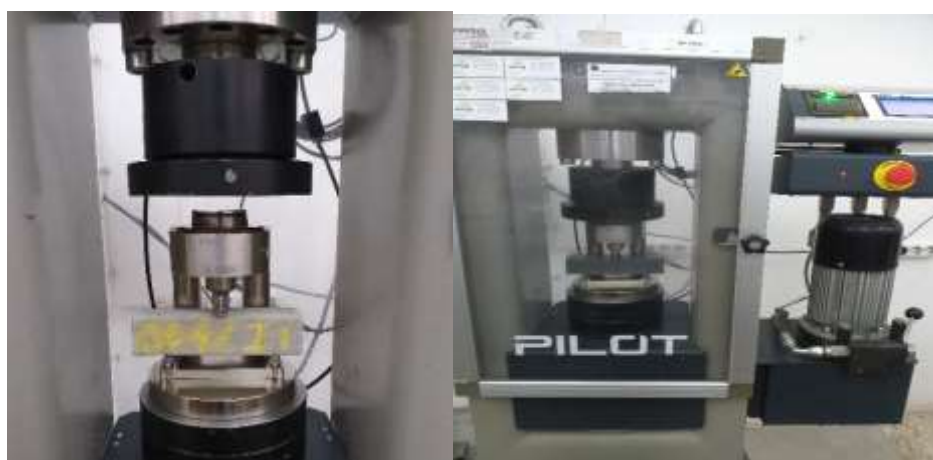
Figura 12: Ensaio de resistência à tração por flexão
