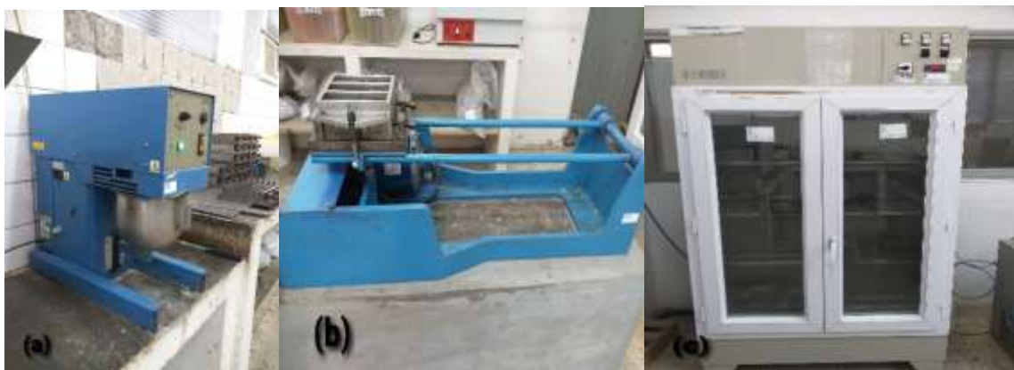
Figura 10: (a) Misturador mecânico, (b) compactador mecânico, (c) câmara de cura usado para preparação da argamassa
