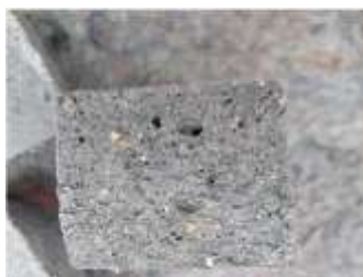
Figura 13: Metades resultantes do ensaio de resistência à tração por flexão
