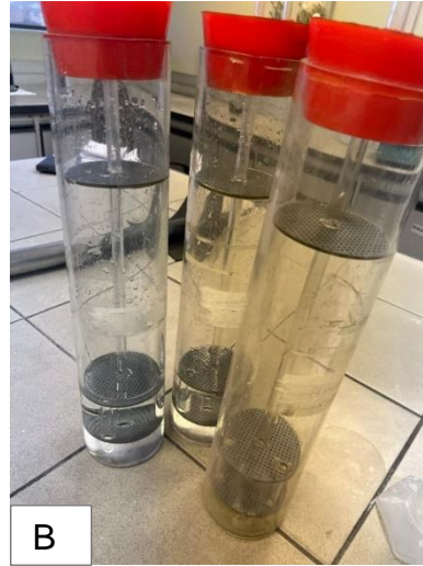
Figura 18: Equipamento usado para a amostragem: A- sonda ligada ao suporte do filtro; e B- borbulhadores.
