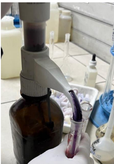
Figura 21: Adição do reagente alizarina aos balões volumétricos.
