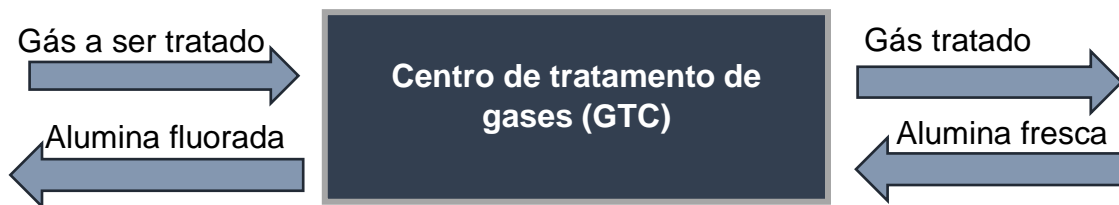
Figura 11: Diagrama de fluxo do processo usado no Centro de Tratamento de Gases.
