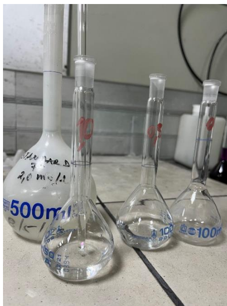
Figura 22: Soluções padrão para o traçado da curva de calibração.
