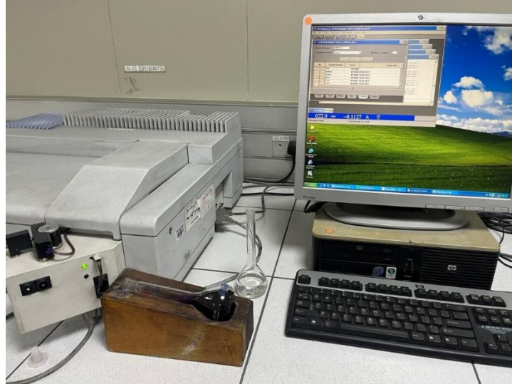
Figura 23: Análise das amostras por espectroscopia com recurso ao equipamento UV-VIS.
