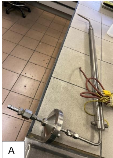
Figura 18: Equipamento usado para a amostragem: A- sonda ligada ao suporte do filtro; e B- borbulhadores.
