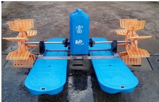
Figura 13: Equipamento de Aeração (Aerador do tipo Pá) - Fonte: A autora
