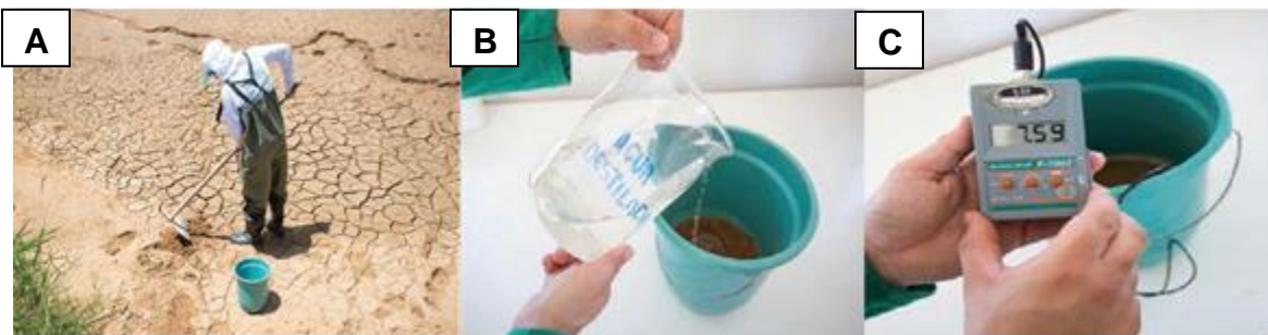
Figura 12: A- Coleta da amostra. B- Mistura da água com solo. C- Determinação de pH do solo- Fonte: A autora
