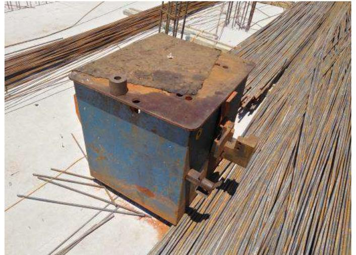
*Figura 33 – Máquinas usadas para dobrar o ferro*
