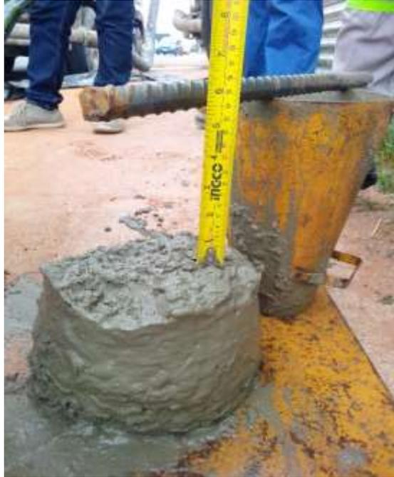
*Figura 37 – Realização do ensaio de abaixamento do cone de Abrams*
