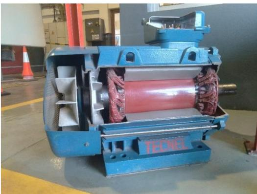
Figura 1. Motor elétrico trifásico em corte, da Tecnel. Fonte: Autor
