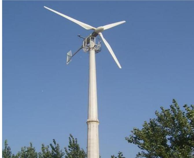
**Figura 11: Turbina eólica de eixo horizontal. Fonte: [10]**
