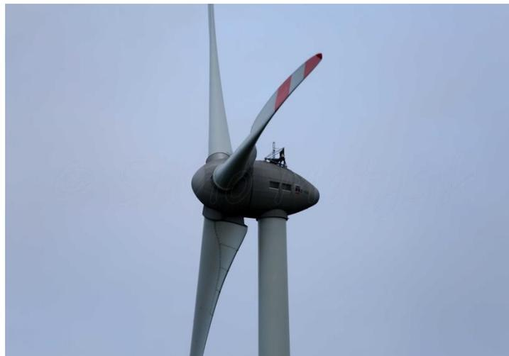
**Ilustração 4: Turbina eólica do modelo Enercon e-101 e2 3.500. Fonte [12]**
