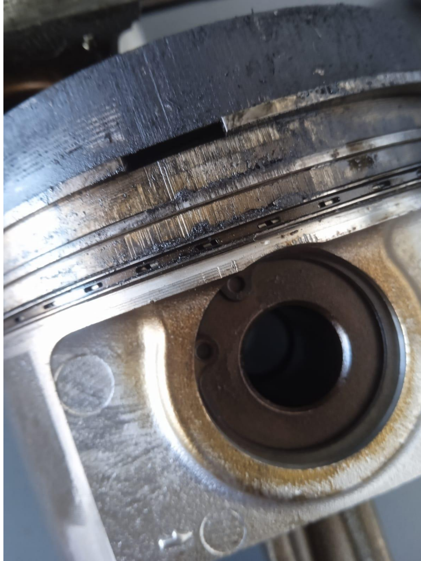
Figura 12: pistão e os anéis que sofreu com desgaste devido a falha do sistema de lubrificação.
