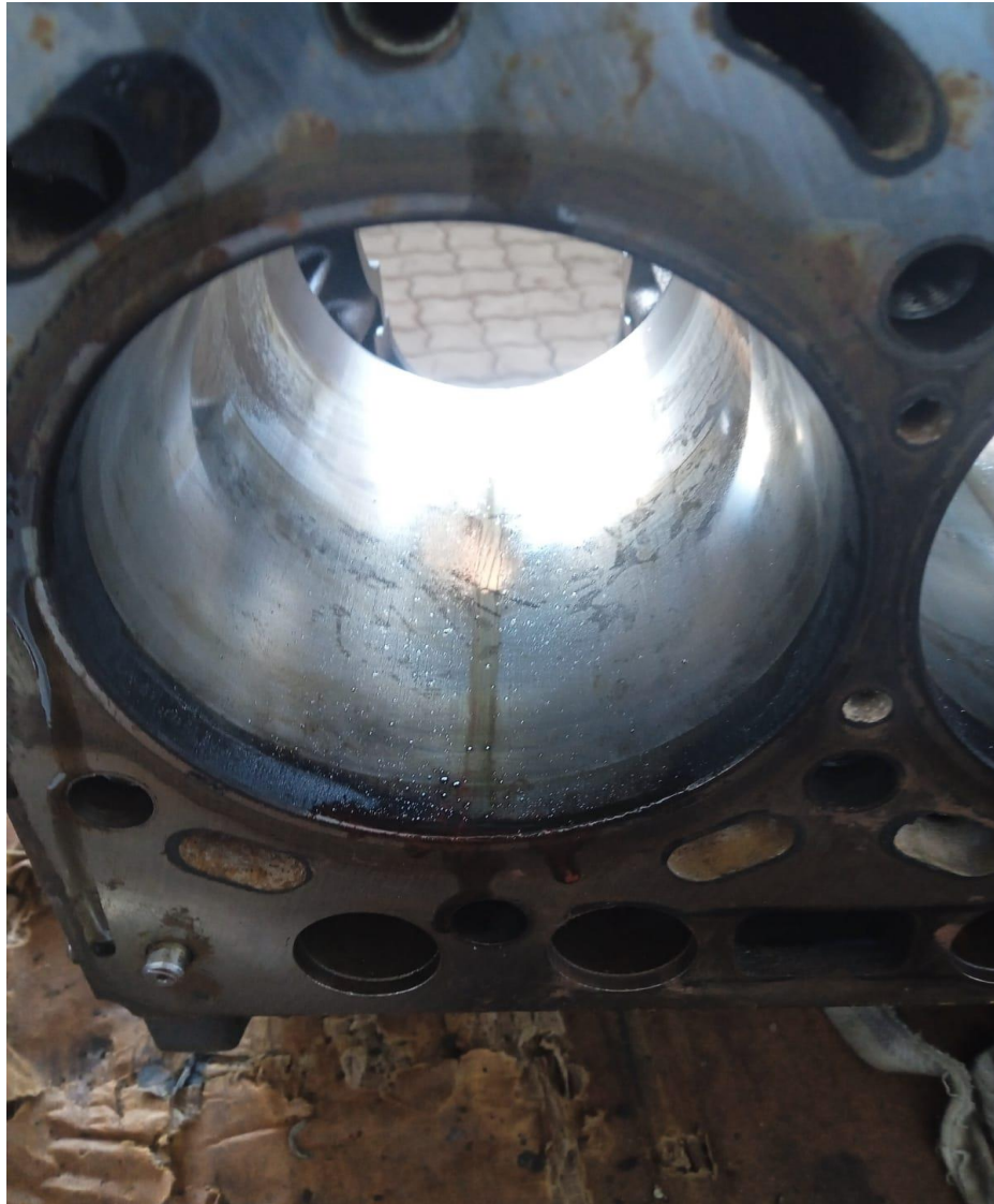
Figura 11: camisa desgastado devido a fricção.
