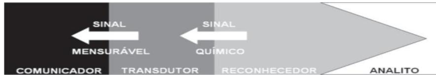
**Figura 3:** Principais Componentes de um Sensor Eletroquímico
