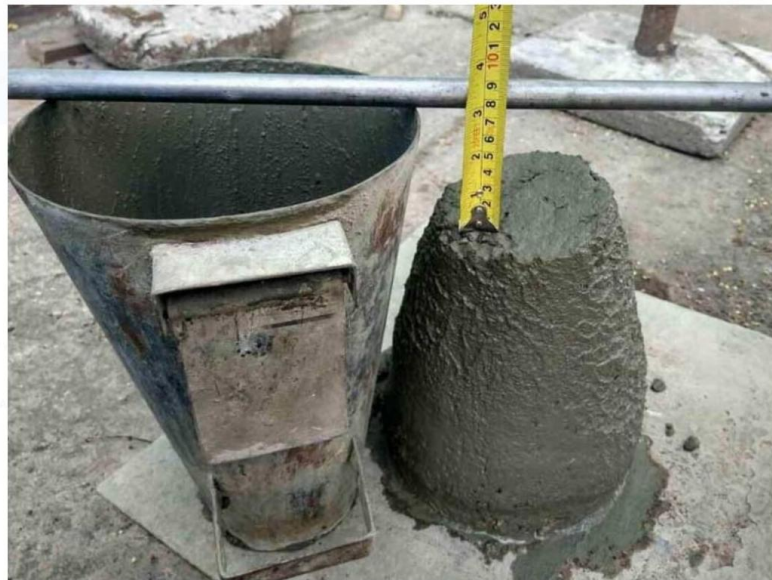
Figura 24: Verificação do rebachamento do betão (fonte autor)
