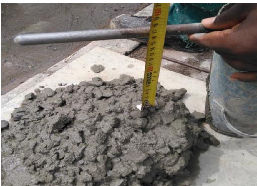
Figura 20: Teste de slump (fonte - autor)
