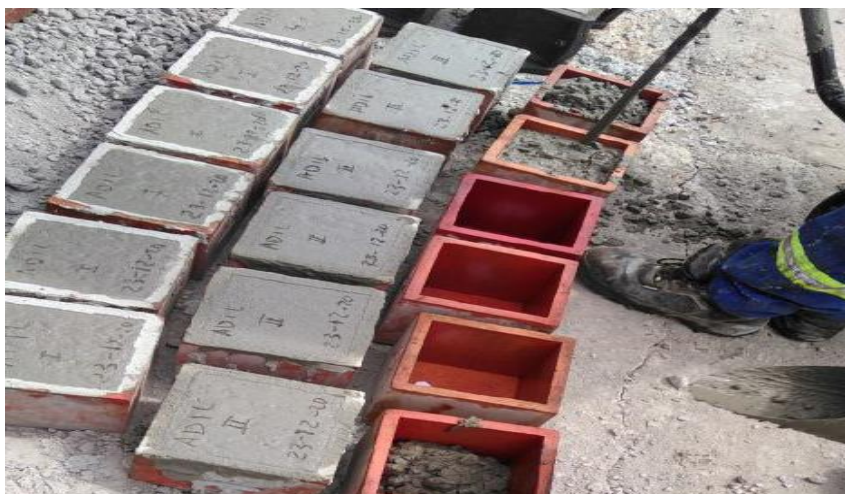
Figura 21: Próvetes para o ensaio de compressão do betão (fonte - autor)
