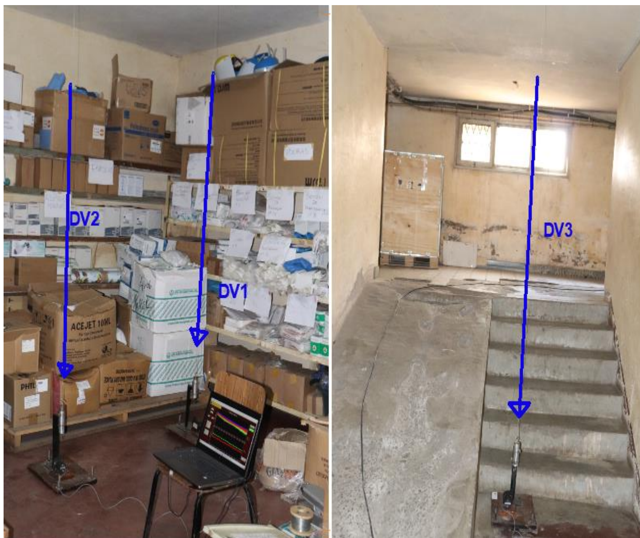
Figura 35. Sistema de medição das deformações do 2º piso.
