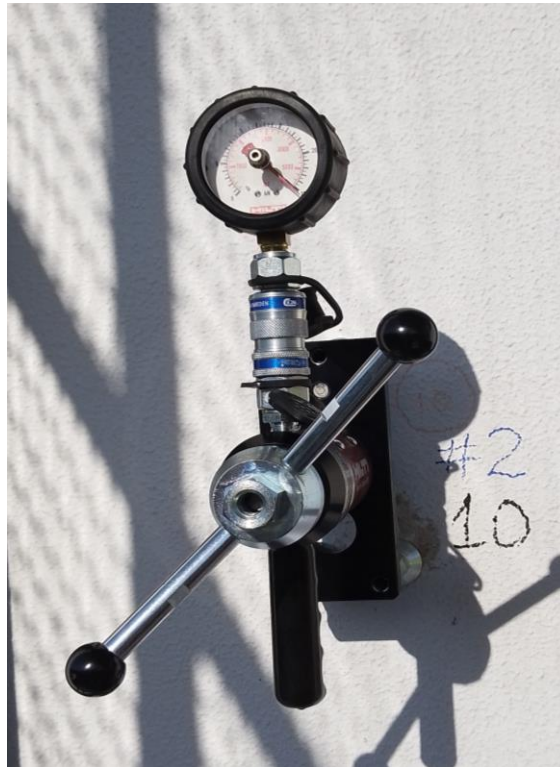
Figura 14. Aparelho de arrancamento pull-out.
