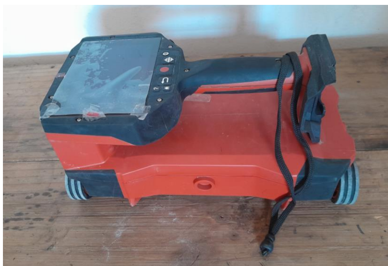
Figura 8. Detector de armaduras.
