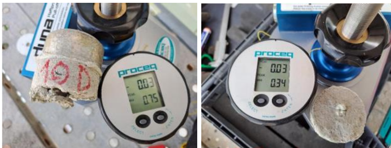
Figura 28. Rotura (a) por aderência e (b) coesão da camada de reboco.
