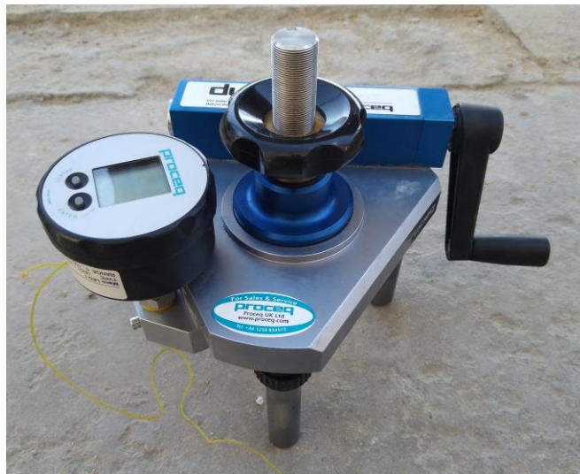
Figura 12. Aparelho de arrancamento pull-off.
