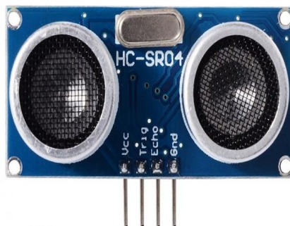
Figura 12: Sensor de Distância Ultra-sônico HC-SR04. Fonte: Sensor de Distância Ultra-sônico HC-SR04 – Flip Flop
