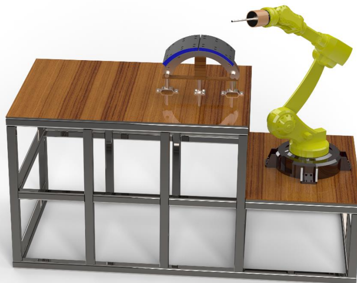
Figura 4.22. Design final do projecto: ferramenta de corte montada. Fonte: Autor
