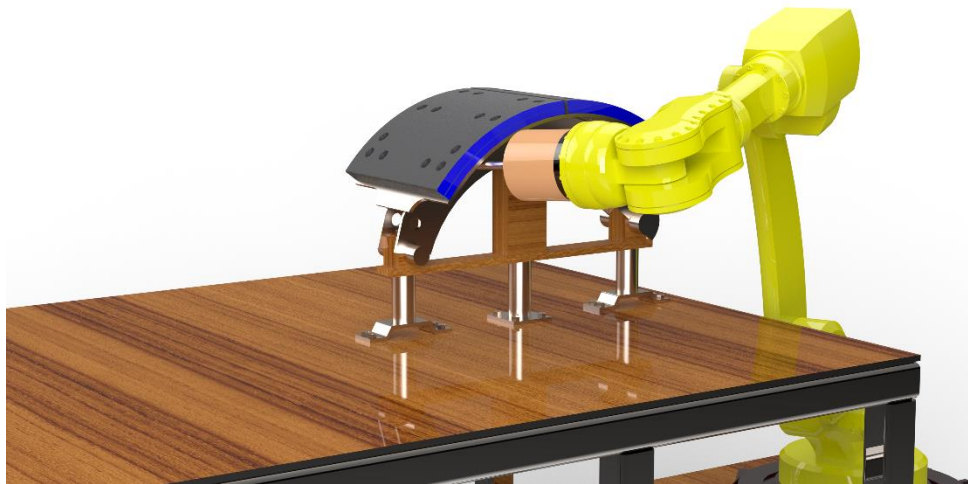
Figura 4.23. Design final do projecto: processo de corte de rebites. Fonte: Autor
