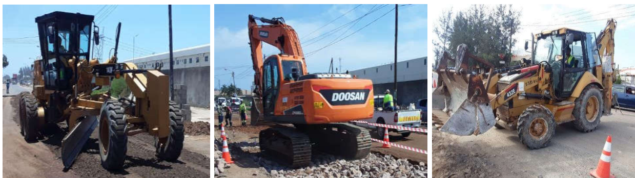
Figura 36: Motoniveladora, Escavadora/ Giratória e retroscavadora – Fonte: Adaptado pelo autor (2022)
