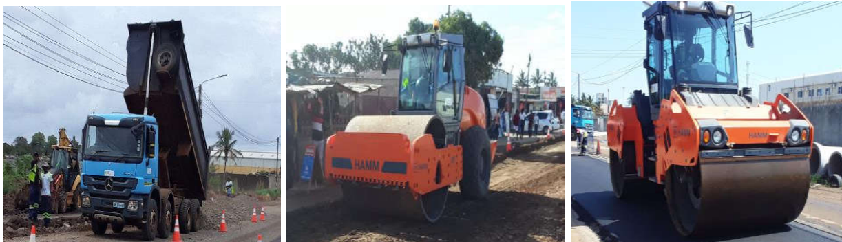
Figura 38: Camião basculante, Cilindro de rolo liso e Cilindro estático liso – Fonte: Adaptado pelo autor (2022)
