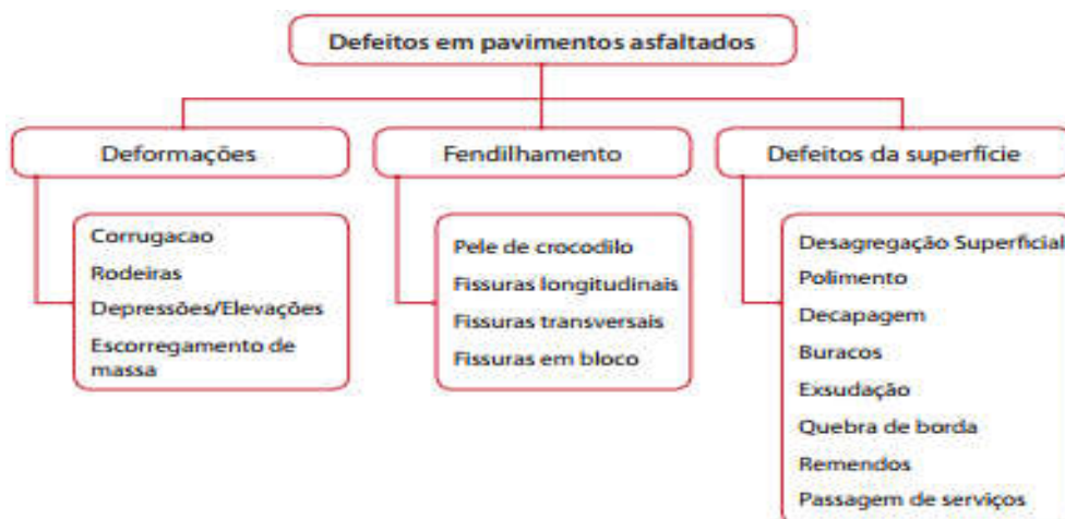
Figura 7: Defeitos em pavimentos asfaltados - Fonte: MOPHRH (2021)
