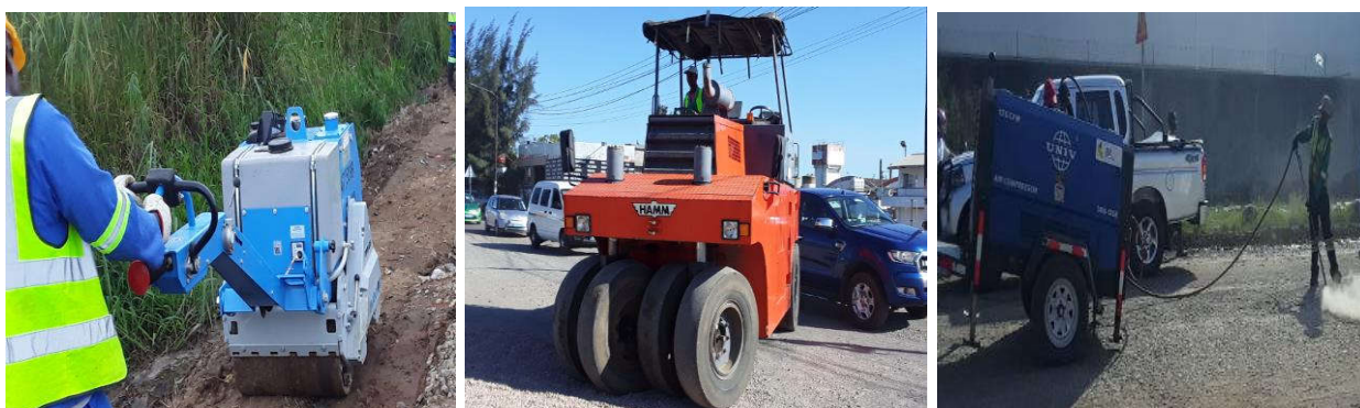
Figura 39: Cilindro pedestre, Compactador de rolos pneumáticos e Compressor de ar – Fonte: Adaptado pelo autor (2022)
