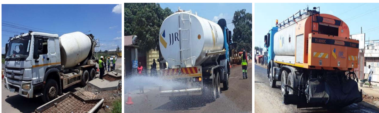
Figura 37: Betoneira, Camião aspersor de água e camião cisterna – Fonte: Adaptado pelo autor (2022)
