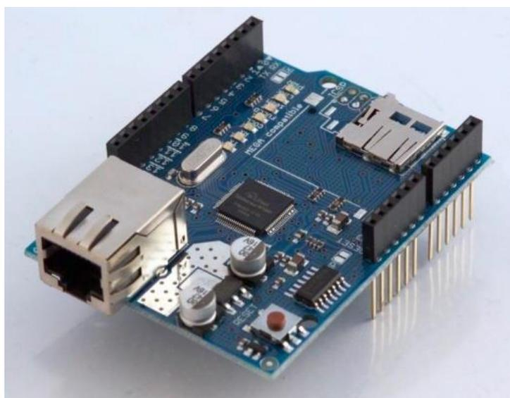
Figura 8: Arduíno Ethernet Shield
